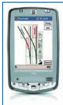
● Inspectiescherm voor een wissel. Foto: Inspectionation
